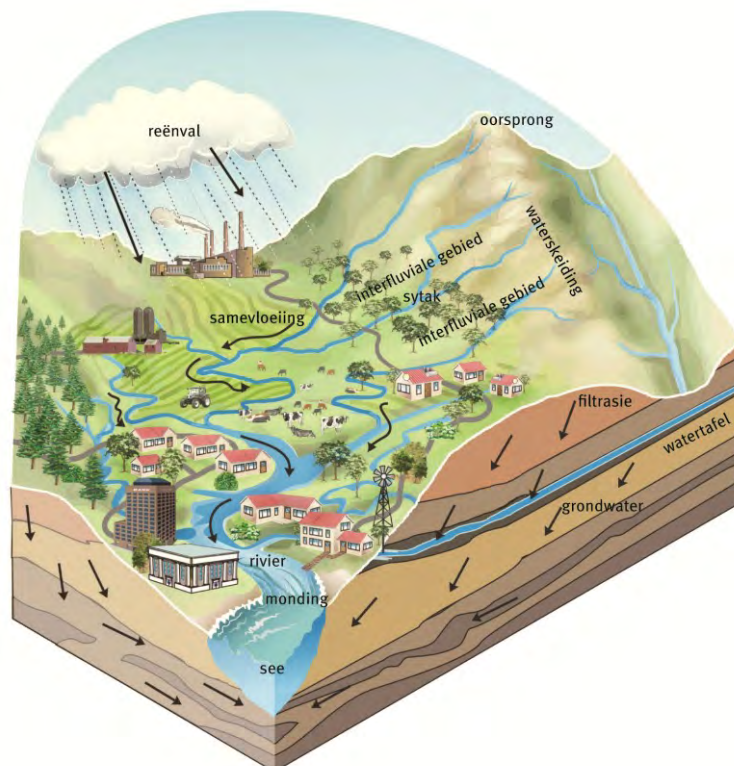
Figuur 35 Komponente van 'n dreineerbekken
